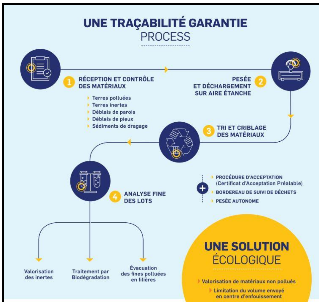
PROCEDE DE TRAITEMENT DE DECHETS Source : BREZILLON
